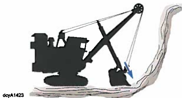
Figura 7-1 Forzar el Reborde del Balde en el Banco
