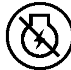
Interruptor general de la batería DESCONECTADO
