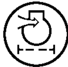
Restricción del filtro de aire del motor
