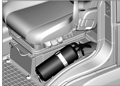
Posición del extintor
