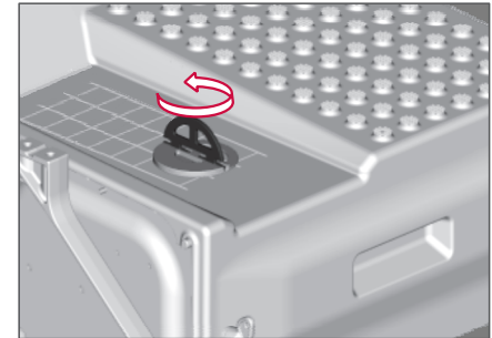
Palomilla de la cubierta de la batería.
