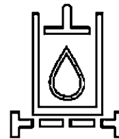
Alarma del filtro de aceite hidráulico
