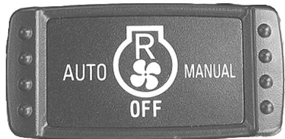
Interruptor de inversión del ventilador de enfriamiento-Si existe
